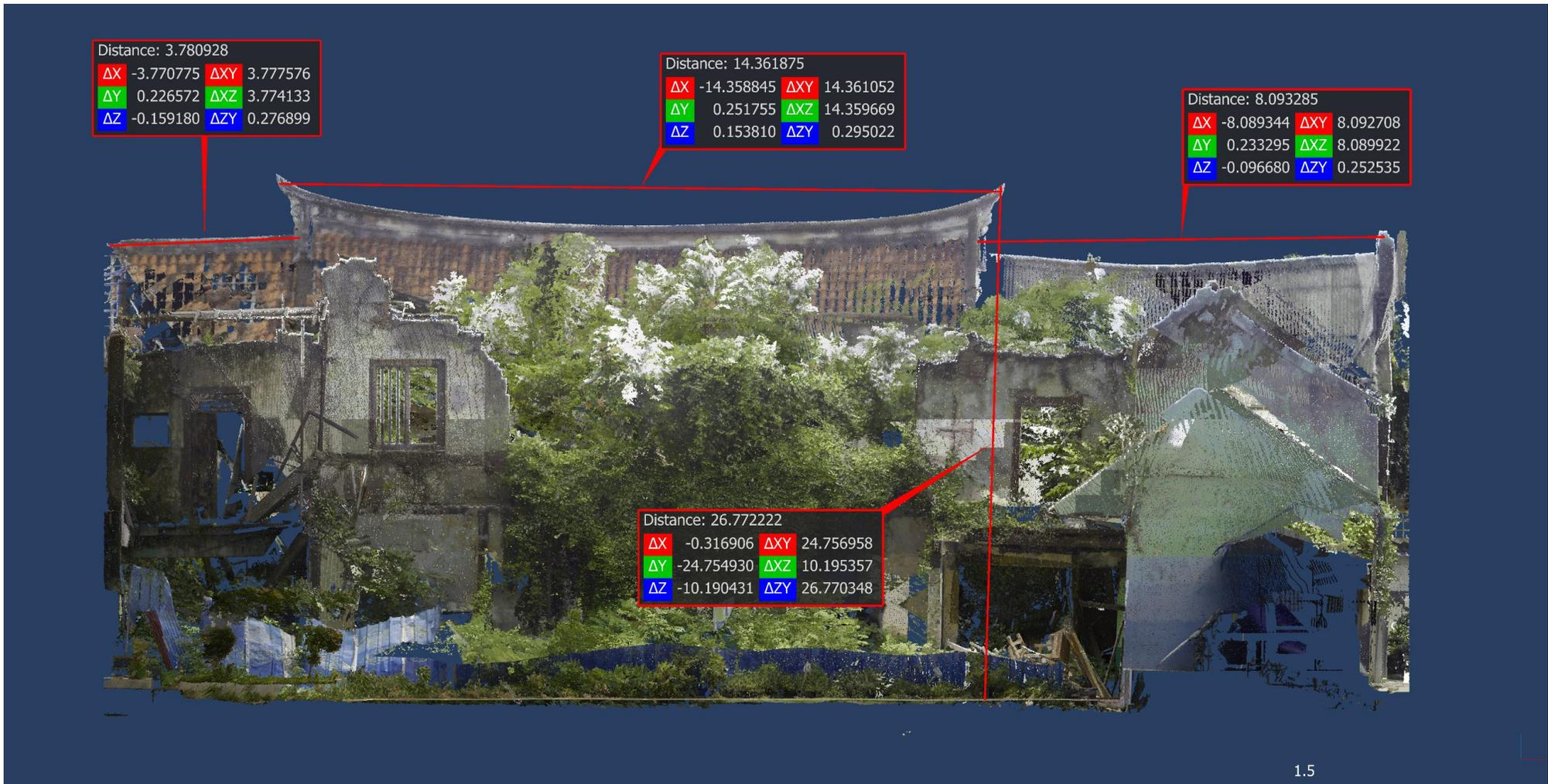
Gambar 13. Hasil pemindaian 3D laser scanning SMP 32 tampak depan (front view)
